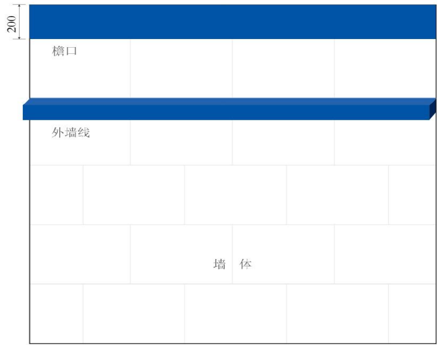
图 A. 19 檐口和外墙线制作示意图
